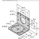
bride de fixation, à angle droit, acier inoxydable, pour les détecteurs avec filetage 30 mm, trous de forage larges pour un alignement précis
