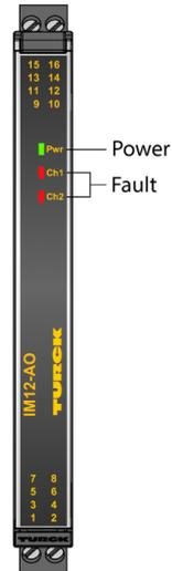
El separador de señal IM12-AO01-2I-2I-HPR/24V CC de dos canales transmite la señal de corriente normalizada y aislada galvánicamente en una relación 1:1. Además de la señal analógica, las señales de comunicación digitales HART® también se pueden transmitir bidireccionalmente. Aplicaciones típicas son la activación de convertidores I/P o en equipos de indicación. El dispositivo se puede alimentar desde un puente de alimentación que también transmite una señal de falla colectiva.
