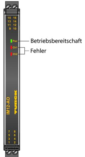
Über den 2-kanaligen Signaltrenner IM12-AO01-2I-2I-HPR/24VDC wird das normierte Stromsignal 1:1 galvanisch getrennt übertragen. Neben dem Analogsignal können bidirektional auch digitale Signale der HART®-Kommunikation übertragen werden. Typische Anwendungen sind die Ansteuerung von I/P-Wandlern oder Anzeigegeräten. Das Gerät kann über eine Power-Bridge versorgt werden, die auch eine Sammelstörmeldung überträgt.
